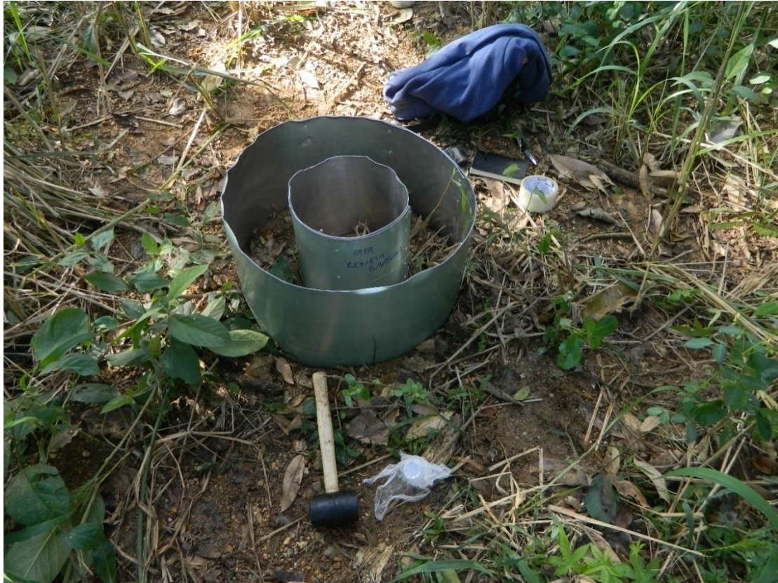
Figura 4: Fixação dos anéis.
