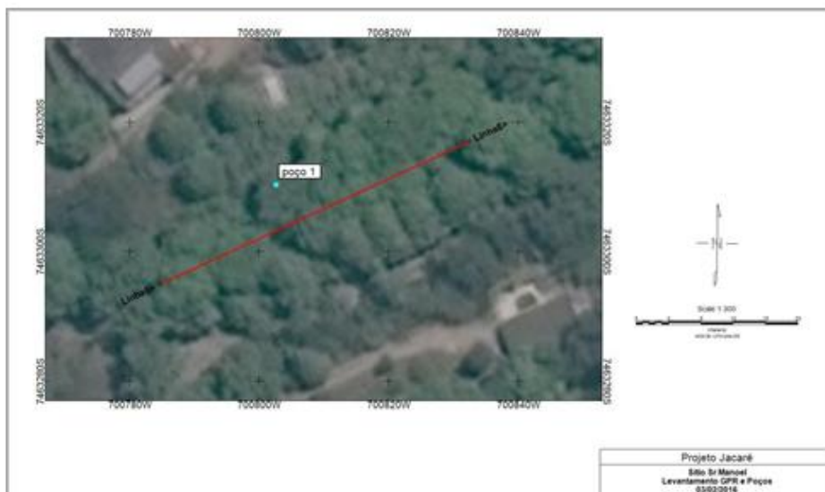
Figura 48: Mapa do levantamento com GPR no Sítio Sr. Manoel. Próximo ao centro da imagem está localizado o poço no. 1 utilizado como referência.
