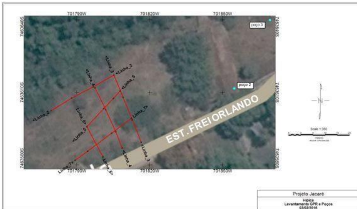
Figura 42: Mapa das linhas de levantamento com GPR na Hípica com os poços 2 e 3 marcados em azul claro no canto direito superior.
