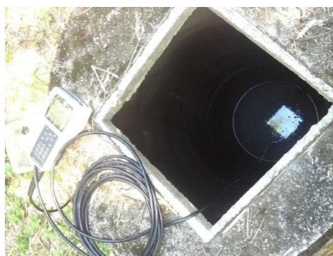
Figura 35: Poço 5 a norte do Poço 4 e cota topo gráfica de 117,37 metros. O poço foi recarregado naturalmente.
