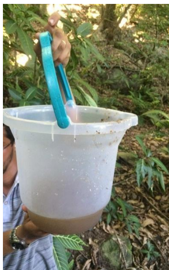
Figura 29: Coleta de água em balde graduado onde é possível estimar a vazão controlando-se o tempo e volume.
