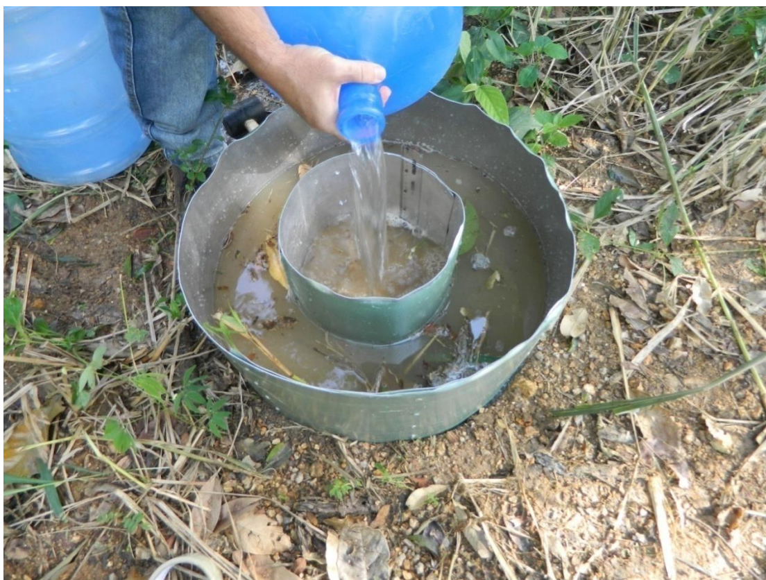
Figura 7: Preenchimento do anel interno até a marca de 20 cm.
